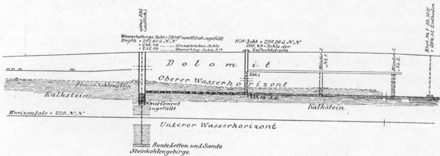
Abb. 12. Profil durch das Wasserhebewerk Rosaliegrube.
